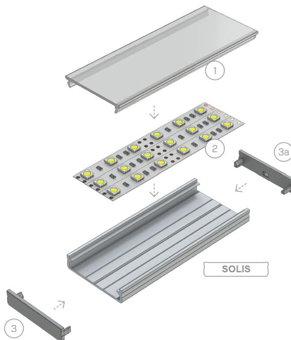
Montageschema zum Beleuchtungssystem bestehend aus folgenden Elementen: Profil SOLIS und (1) Abdeckung WIDE, (2) drei LED-Streifen, (3) Endkappe ohne Öffnung, (3a) Endkappe mit Öffnung
