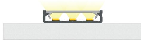
Fertiges Resultat nach der Montage des Profils SOLIS mit Abdeckung WIDE mit Hilfe von doppelseitigen Bandes
