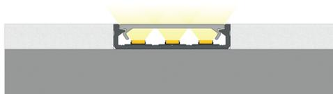
Fertiges Resultat nach der Montage des Profils SOLIS mit Abdeckung WIDE eingelegt zwischen die Platten
