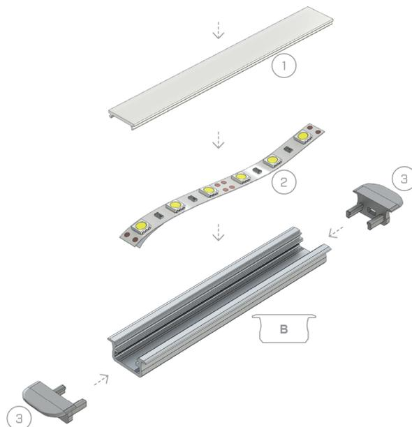
Montageschema zum Beleuchtungssystem bestehend aus folgenden Elementen: Einlegeprofil B und (1) Abdeckung BASIC, (2) LED-Streifen, (3) abgerundete Endkappen mit Öffnungen
