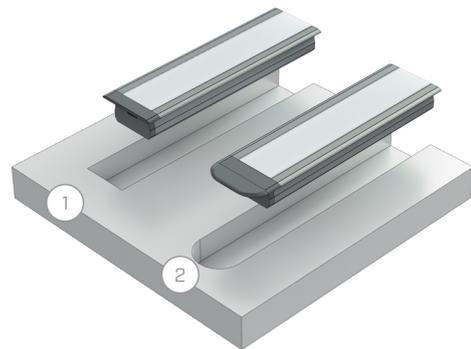
Parallelprojektion vor der Montage des Profils B in gefräster Öffnung (1) mit flacher Endkappe, (2) mit abgerundeter Endkappe
