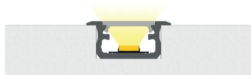
Fertiges Resultat nach der Montage des Einlegeprofils B mit Abdeckung BASIC
