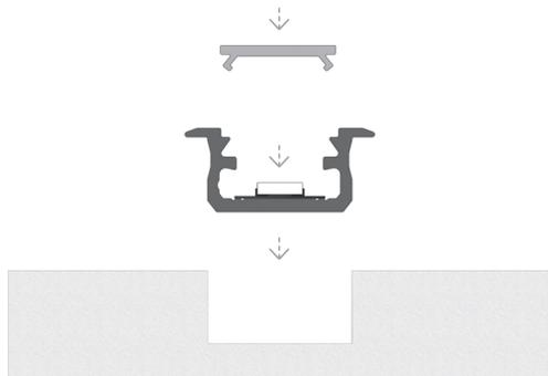
Montageanleitung für das Einlegeprofil B mit Abdeckung BASIC
