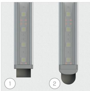
Montage des Profils B in gefräster Öffnung (1) mit flacher Endkappe, (2) mit abgerundeter Endkappe
